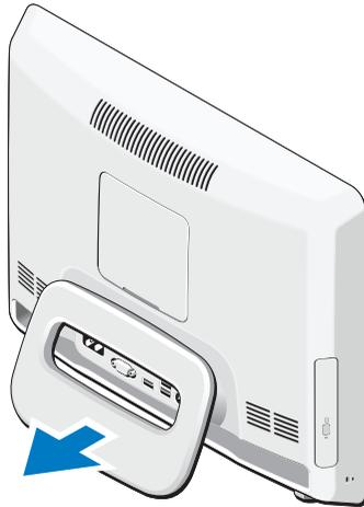
Vostro 320 还支持 UL 认证 VESA 墙壁支架（仅限 100 毫米 x 100 毫米）。
